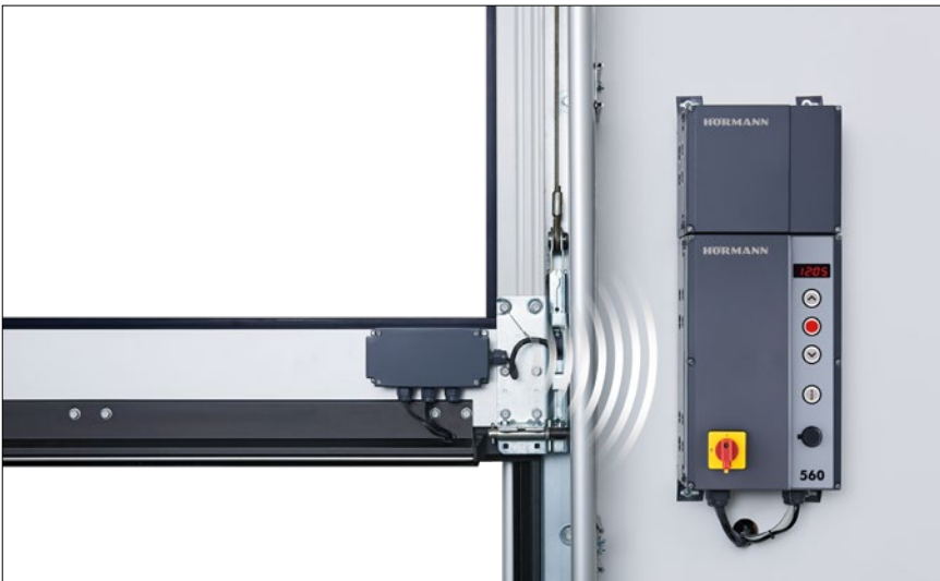
Radioöverföringsenhet För överföring av signaler från portbladet till styrsystemet via Bluetooth (ingen spiralkabel), strömförsörjning via ett effektivt batteri. Komponenter som kan anslutas: optosensorer LE (low energy), medlöpande fotocell VL1-LE / VL2-LE, 8k2-list, slaktlinebrytare, gångdörrskontakt, nattläsningskontakt
